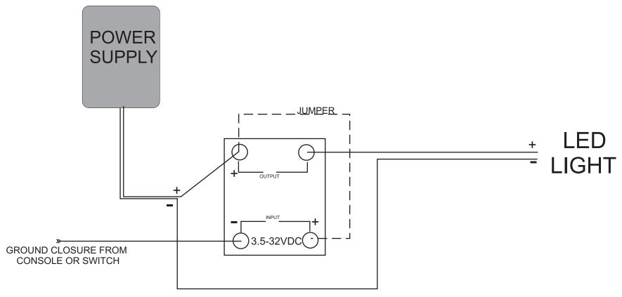
USE A SINGLE POWER SUPPLY TO PROVIDE +DC TO BOTH THE RELAY AS WELL AS THE LOAD DEVICE. ENSURE THE POWER SUPPLY GND IS THE SAME AS THE RELAY GROUND CLOSURE.
